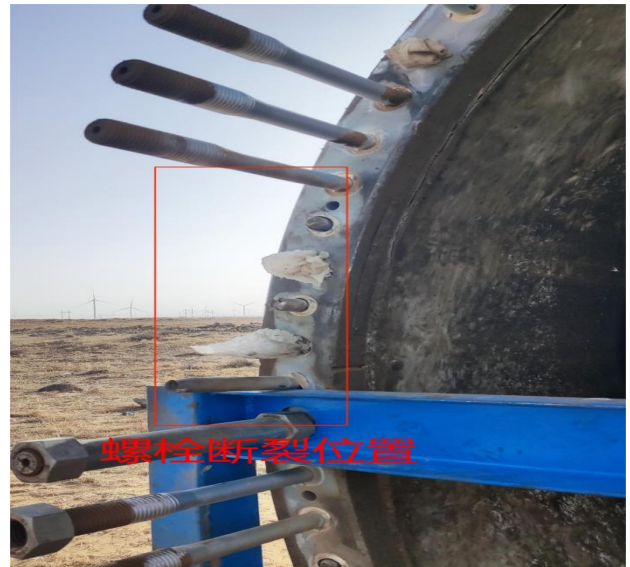
图 4 事故现场（叶根内部）
